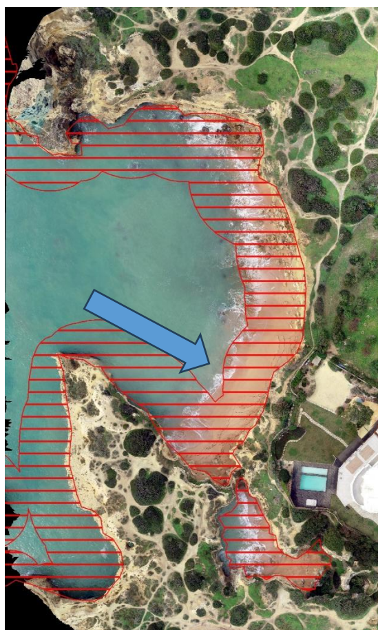
Fig 8 - Faixas de risco das arribas na praia da Ponta Grande, no concelho de Albufeira.
